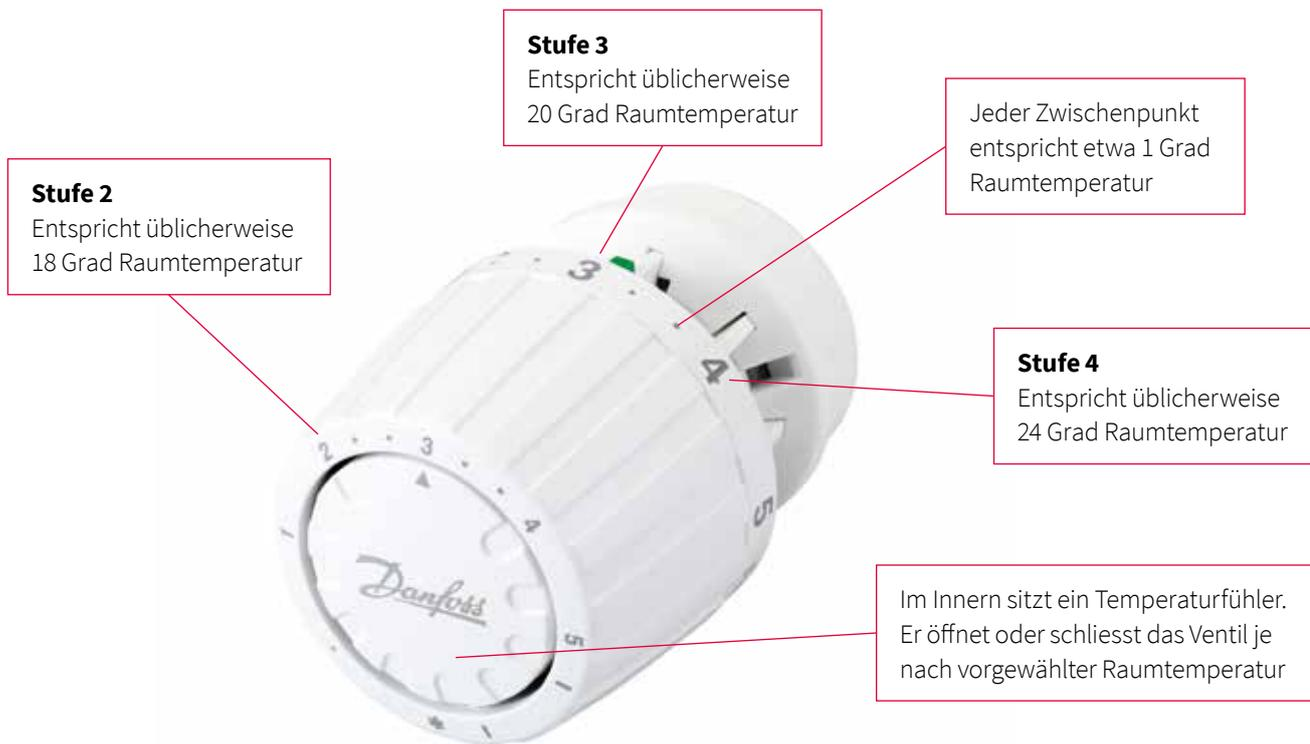
Wichtig ist, die Thermostatfühler beim Lüften ganz zu schliessen. Fällt kalte Aussenluft auf den Thermostaten, öffnet er das Ventil zum Heizkörper ganz, um den vermeintlich kalten Raum aufzuheizen.
